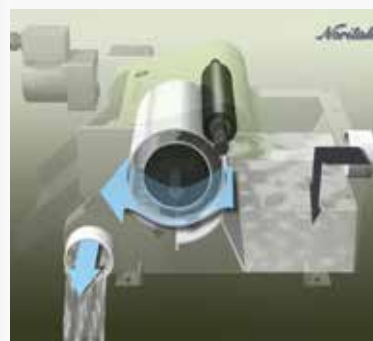
図15 従来のマグネットセパレーターの流路構造
