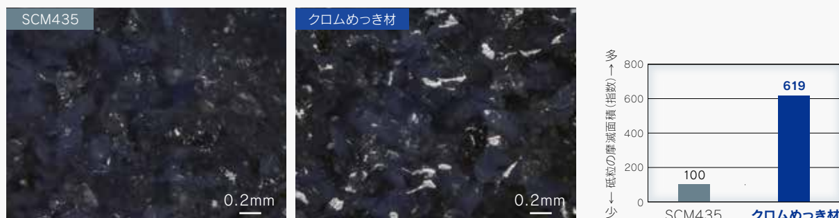
図4 研削後の砥石面状態と砥粒摩滅面積
