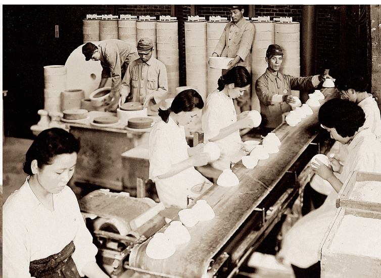
食器と磁石を混焼する焼成工場（昭和15年頃）
