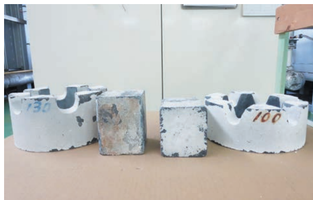
焼成治具の高さ見直し（左：変更前、右：変更後）
