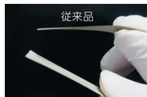
耐熱試験後の導電性樹脂銀ペースト(200℃×10時間)
