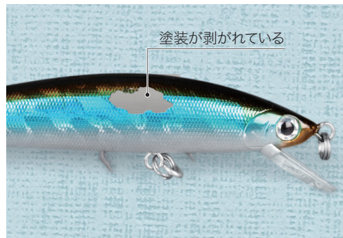
図7 一般的なルアーの破損例
