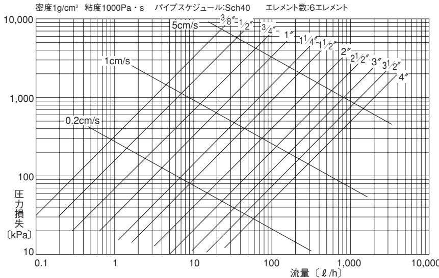
高粘度流体 (Re数10以下) の場合は粘度の倍数がそのまま圧力損失の倍数となります。
