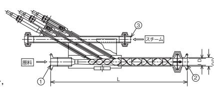
ノリタケクッカーは、高粘度流体をスチームで直接加熱する加熱器です。スチームヘッダー、ノズル、および分散凝縮部であるスタティックミキサーにより構成されています。高粘度流体中に注入されたスチームは強制的に攪拌されますので、瞬時に凝縮・加熱ができます。したがって目的とする温度まで瞬時に昇温することが可能です。また、澱粉系原料のように、加熱により粘度が急上昇する液に対しても使用可能で、食品、紙パルプ、化学業界で幅広く採用されています。また、スチーム凝縮時に発生する騒音・振動はほとんどなく、均一な温度分布の液が速やかに得られ、温度コントロールも容易かつ正確です。形状がシンプルなので、CIP洗浄、分解洗浄も容易です。
