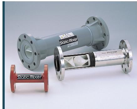
エレメントは特殊なグレーズ（上釉）処理をしたセラミックスを使用しています。表面は滑らかでスケールが付着しにくく、耐摩耗性にも優れています。各種材質のハウジングを用意していますので、流体の特性により選択することができます。水処理プロセスをはじめ、化学プロセスで用いられています。
