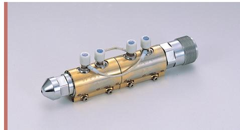
ポリマーミキシングノズルはスタティックミキサーの応用機器として射出成形機用に開発されたミキシングノズルです。エレメントとハウジング内面はバフ研磨仕上げされています。現在お使いのノズルをポリマーミキシングノズルに交換するだけで、製品のグレードアップ、品質の安定化、着色剤の節約などに寄与します。
