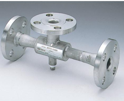
スチームミキサーはスチームと液体を直接混合し、液体を加熱するミキサーです。スチームを噴射するノズル部と、分散凝縮部であるスパイラルエレメントから構成されています。スパイラルエレメントを用い、インラインでスチームを液中に直接分散凝縮するため、スチームの持つ全熱量が利用でき、液温の安定性に優れています。またタンク加熱方式で問題になっているスチーム凝縮時に発生する振動・騒音を大幅に軽減できます。
