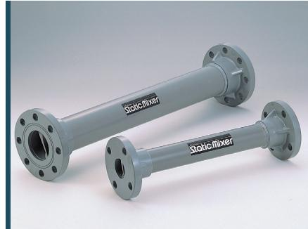
エレメント、ハウジング、フランジ共に、PVC製のスタティックミキサーで、前後配管がPVC製の場合に用いられます。おもに上水、純水の水処理用に用いられています。耐衝撃性PVC、耐熱PVCでも製作できます。また、FRP外被による補強も可能です。
