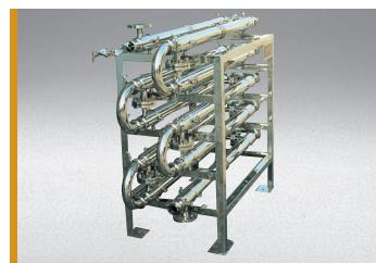
接液部はすべてサニタリー仕上げされていますので、CIP洗浄が可能です。またエレメントの抜き出しが容易で分解洗浄も簡単に行うことができます。
