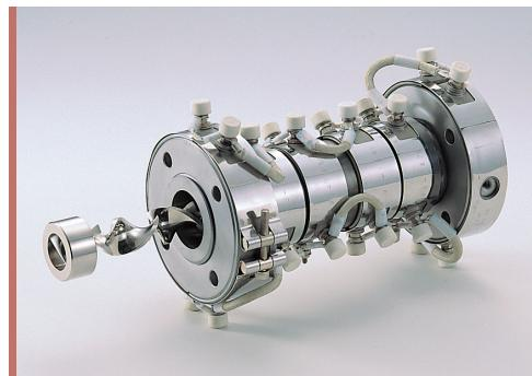
エレメントはバフ研磨仕上げ、バレル内面はハードクロムメッキされています。熱可塑性樹脂の溶融状態における温度分布を均一にできます。サーモミキサーを押出成形機に装着することにより押出機で発生する溶融ポリマーの温度ムラ(粘度ムラ)を改善でき、より厳密な温度管理が可能となり、製品の品質向上及び生産の安定に寄与します。(実用新案登録済フィルム製造ダイ)
