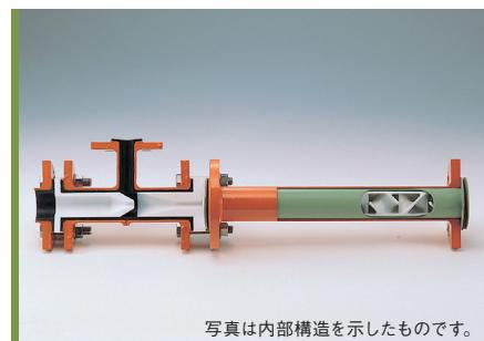
ウォータージェットミキサーはディスパージョンミキサーに吸引機能を備えた気液及び液々分散器です。苛性ソーダによる低圧塩素ガスの吸収反応プロセス、オゾンガス・アンモニアガス等の溶解プロセスで使用されています
