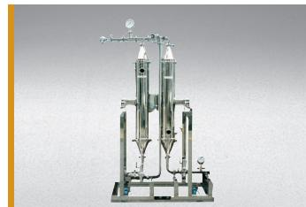
従来のプレート型熱交換器では行えなかった固体物の入ったタレや、高粘性の原料にも対応できます。
