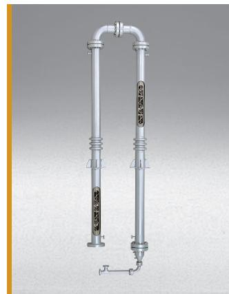
ノリタケ リアクターは静的連続塊状重合を行う管形反応器です。エレメントの攪拌効果により、流体はピストンフローとなり均一な重合物が得られます。おもに化学工業におけるポリスチレン、ポリメチルメタアクリレート、ポリウレタン弾性繊維の重合プロセスやポリプロピレンの熱分解反応、樹脂のマレイン化反応、スルフォン化反応等に利用されています。
