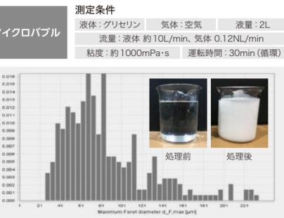
測定機器 : SOPAT GmbH社 フロー式画像解析粒子径・形状分析装置 SOPAT
