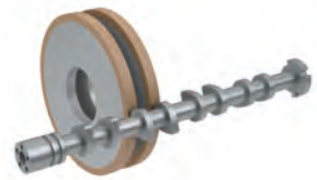
図10 カムプロファイル研削の概略図
