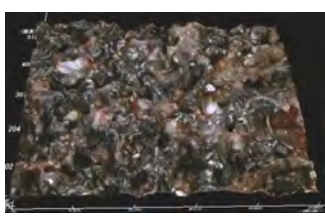
図18 研削後の砥石面状態
