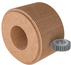
図34 連続創成式歯車研削の概略図
