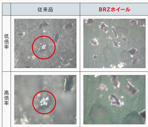
(d) 研削後のホイール面状態 ※○:先端が摩滅している砥粒
