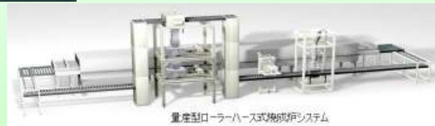
量産型ローラーハース式焼成炉システム
