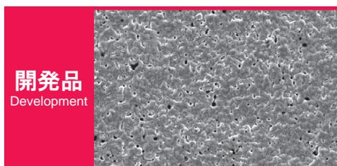
Al<sub>2</sub>O<sub>3</sub> 基板上 Alumina substrate
