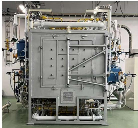
▲水素燃焼式焼成炉の外観
