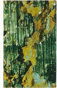
● 高圧クーラント無し (金属溶着が見られる)
